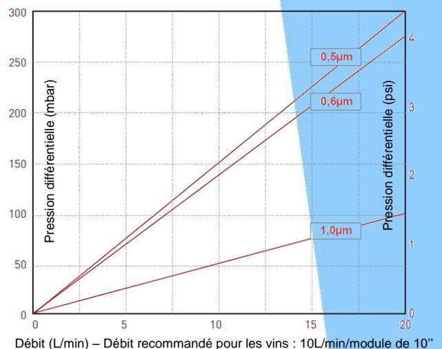
Débit (L/min) – Débit recommandé pour les vins : 10L/min/module de 10"
